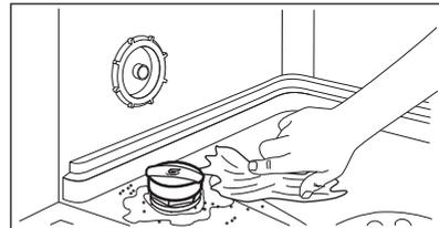
5. Drehen Sie den Deckel des Salzbehälters im Uhrzeigersinn, um den Salzbehälter zu schließen.
