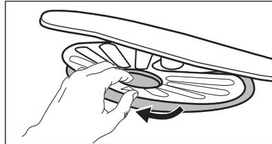
4. Reinigen Sie die Filter.
