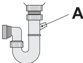
**i** Nos appareils sont équipés d'un dispositif de sécurité empêchant le reflux des eaux usées vers l'appareil. Si le robinet de votre évier est doté d'un clapet de retenue incorporé, cela pourrait entraver la vidange correcte de votre lave-vaisselle. C'est pourquoi nous vous recommandons de le retirer.
