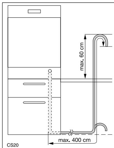
De même, les raccords utilisés pour le branchement doivent avoir un diamètre intérieur non inférieur à celui du tuyau d'évacuation.
