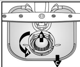
Dévissez le corps cylindrique du filtre, dégagez-le avec le filtre fin...
