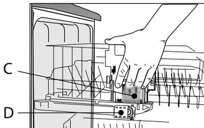
**Retrait du plateau à couverts et/ou du panier supérieur** (si cette fonction est disponible) - Il peut être nécessaire de retirer le plateau à couverts pour ranger des verres à pied dans le panier supérieur et/ou de retirer le panier supérieur pour ranger des pièces volumineuses dans le panier inférieur.
