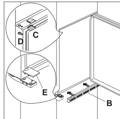
4. Appliquez la grille d'aération (B) et le couvrecharnière (E- Fig.). Appliquez les caches (C-D) sur les ailettes des butées et dans les trous des charnières (Fig.).
