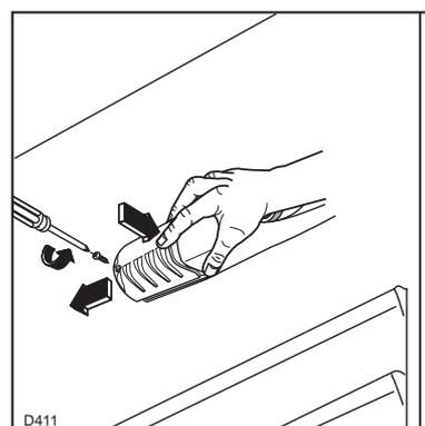
4. Dévissez l'ampoule et remplacez-la par un modèle semblable (max. 15 W).
