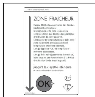
Si "OK" n'apparaît pas, la température moyenne de la zone est trop élevée. Réglez le thermostat sur une position supérieure.
