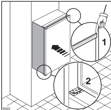
1. Glissez l'appareil dans la niche en l'appuyant contre la paroi intérieure, correspondant au côté d'ouverture de la porte, jusqu'à ce que le cache supérieur soit à fleur (1) et veillez à ce que la charnière du bas soit alignée sur la paroi du meuble (2).
