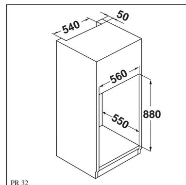
Il est également nécessaire que la niche soit équipée d'un conduit d'aération ayant les mesures suivantes:
