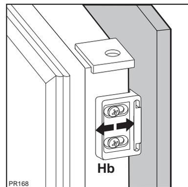
10. Alignez de la porte de l'appareil. A la fin des opérations, il est nécessaire de contrôler que la porte de l'appareil se ferme parfaitement.
