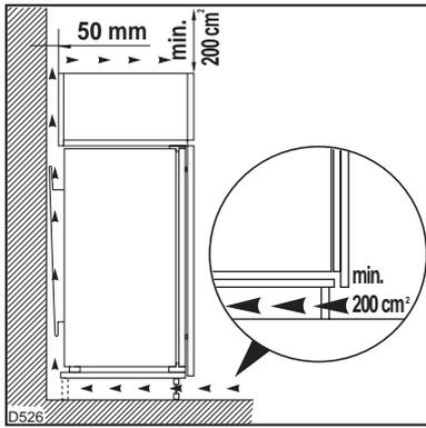
Pour une aération optimale de l'appareil il est obligatoire de pratiquer une ouverture dans le socle (voir Fig.).
