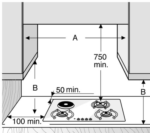
**REMARQUES :** Si la distance "A" entre les éléments muraux est comprise entre 600 mm et 680 mm, la hauteur "B" doit être d'au moins 520 mm.
