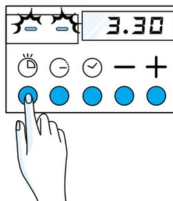
7. En fin de cuisson, le cadran indiquera **-End** et les voyants verts (3) et (5) s'éteindront. Un signal acoustique retentira par intermittence. Pour l'arrêter, appuyer sur une des touches. Le cadran indiquera l'heure.
