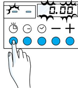
3. Sélectionner le temps de cuisson par les touches (7) et (8) pour diminuer ou augmenter le temps (voir figure).
