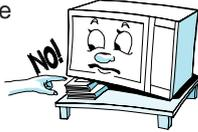
**Placez le four à distance** d'autres sources de chaleur. La température de l'air de refroidissement, absorbée par le four, ne doit pas dépasser 35 °C. Laissez un espace de 20 cm minimum au-dessus du four, afin de garantir une ventilation suffisante. Vérifiez que les pieds de l'appareil sont en place et que l'espace en dessous de l'appareil est dégagé afin de permettre une bonne circulation de l'air. Le four peut fonctionner dans une pièce où la température est comprise entre +5 et +35 °C.
