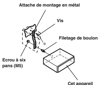
Si votre véhicule possède une applique, installez le long boulon à tête hexagonale sur le panneau arrière du CDE-9848RB/CDE-9846R/CDE-9846RM et placez le bouchon caoutchouté sur le boulon à tête hexagonale. Si le véhicule ne possède pas de support de montage, renforcez l'appareil principal avec une bande de montage métallique (non fournie). Raccordez tous les fils du CDE-9848RB/CDE-9846R/CDE-9846RM de la manière décrite dans la section RACCORDEMENTS.
