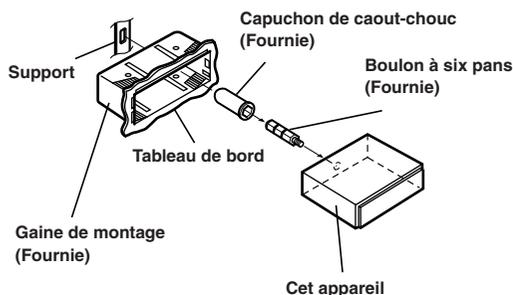
Détachez la gaine de montage de l'appareil principal en la faisant glisser (reportez-vous à la section « Dépose » de cette page.) Glissez la gaine de montage dans le tableau de bord et fixez-le à l'aide des attaches en métal.
