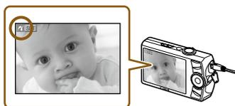
**Mettez d'abord l'imprimante SELPHY sous tension, puis allumez l'appareil photo numérique et lisez les images dessus.**
