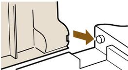
Faites glisser le trou de l'autre côté du couvercle sur l'encoche de l'imprimante.
