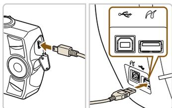
**Connectez l'imprimante SELPHY à l'appareil photo numérique à l'aide du câble USB fourni avec ce dernier.**
