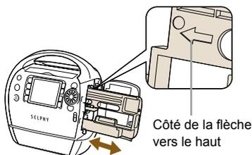
Insérez le bloc de nettoyage dans le compartiment de la cartouche, poussez-le à fond, puis faites-le glisser vers l'intérieur et l'extérieur 2 ou 3 fois.
