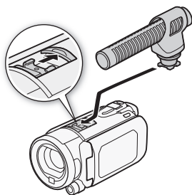
Exemple : fixation d'un microphone stéréo directionnel DM-100 optionnel.
