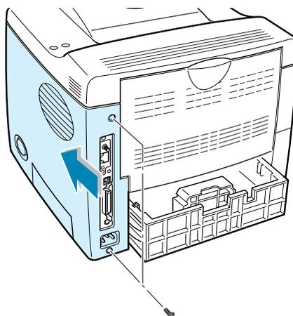
**8** Si vous disposez d'une carte d'interface réseau supportant l'interface LAN sans fil, vissez l'antenne dans son support en la faisant pivoter dans le sens inverse des aiguilles d'une montre, comme indiqué ci-dessous.
