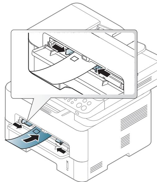
Si les enveloppes sont imprimées avec des ondulations, des froissements ou des lignes noires grasses, ouvrez le capot arrière, puis réessayez d'imprimer. Maintenez le capot arrière ouvert pendant l'impression.
