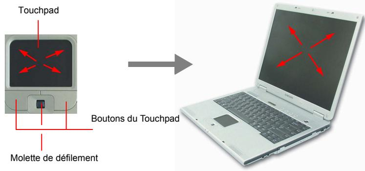
Le Touchpad de l'ordinateur vous permet de déplacer le pointeur sur l'écran LCD, exactement comme le fait une souris utilisée avec un ordinateur de bureau. Les boutons du Touchpad permettent d'exécuter des actions à l'aide du pointeur, telles que la sélection d'un élément ou l'exécution d'une commande. La molette de défilement située entre les boutons du Touchpad permet de faire défiler la zone affichée vers le haut ou vers le bas à l'intérieur de la fenêtre.
