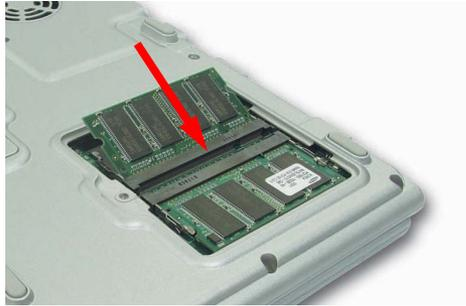
4. Poussez le module jusqu'à entendre un clic, qui signifie qu'il est bien en place. Si le module de mémoire n'est pas correctement fixé, poussez-le de nouveau tout en appuyant sur les pattes de fixation, vers l'extérieur.
