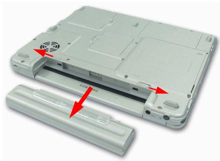
4. Pour réinstaller la batterie, insérez-la en la faisant glisser, comme indiqué ci-dessous. Le loquet se remet en place et fixe automatiquement la batterie.
