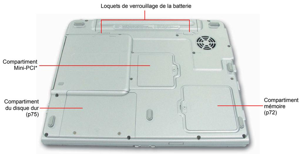
\* Un module de communication sans fil (option, p35) est installé dans le compartiment mini PCI.
