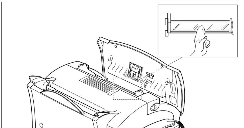
**6. Remettez en place le rouleau en suivant la procédure inverse, puis fermez le panneau de commande vigoureusement jusqu'à ce qu'il s'enclenche.**
