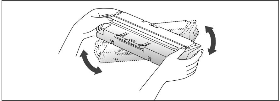
**5. Repérez les rainures de guidage de la cartouche à l'intérieur de l'appareil (une de chaque côté). Saisissez la poignée et faites glisser la cartouche entre les rainures de guidage jusqu'à ce qu'elle soit en place.**
