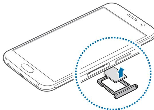
4 Insérez le compartiment pour carte SIM à l'endroit prévu à cet effet sur l'appareil.
