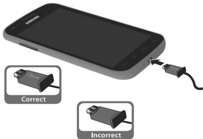
**Nota :** L'illustration ci-dessus montre les méthodes **correcte** et **incorrecte** de brancher le chargeur. Un branchement inadéquat peut endommager la prise. Aucun dommage causé par une mauvaise utilisation n'est couvert par la garantie.
