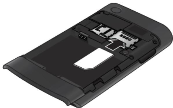
3. Glissez délicatement la carte SIM à l'intérieur du logement jusqu'à ce qu'elle se verrouille. Assurez-vous que les contacts métalliques de la carte microSD soient vers le bas et que l'encoche de la carte soit dans la même position que sur l'illustration.
