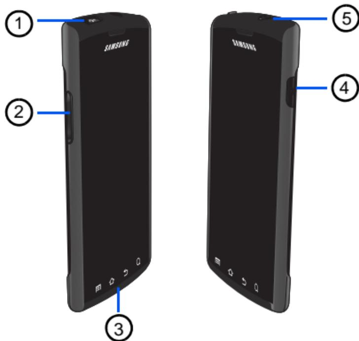
1. **Prise pour câble d'alimentation et accessoires** : permet de brancher un câble d'alimentation ou des accessoires optionnels, comme un câble USB ou de données, ou un casque d'écoute pour des conversations sécuritaires.
