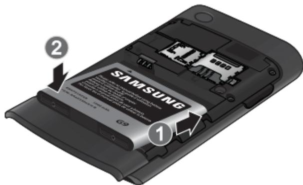
6. Remettez en place le couvercle de la pile (1) et poussez-le (2).
