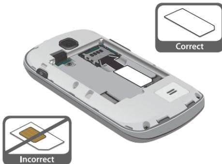
Nota : Si la carte SIM n'est pas insérée correctement, le téléphone ne peut la détecter. Si c'est le cas, réinstallez-la correctement.
