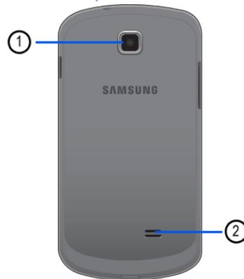
1. Objectif de l'appareil photo : permet de prendre des photos et de saisir des vidéos.
