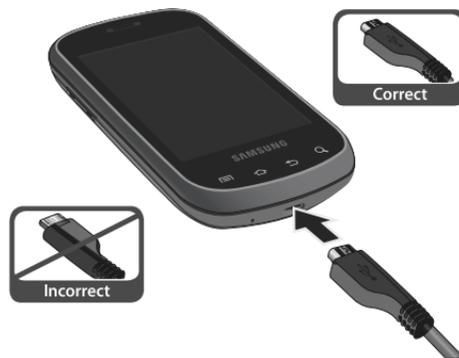
1. Branchez la petite extrémité du chargeur dans la prise multifonction et l'autre fiche dans une prise de courant c.a. ordinaire.
