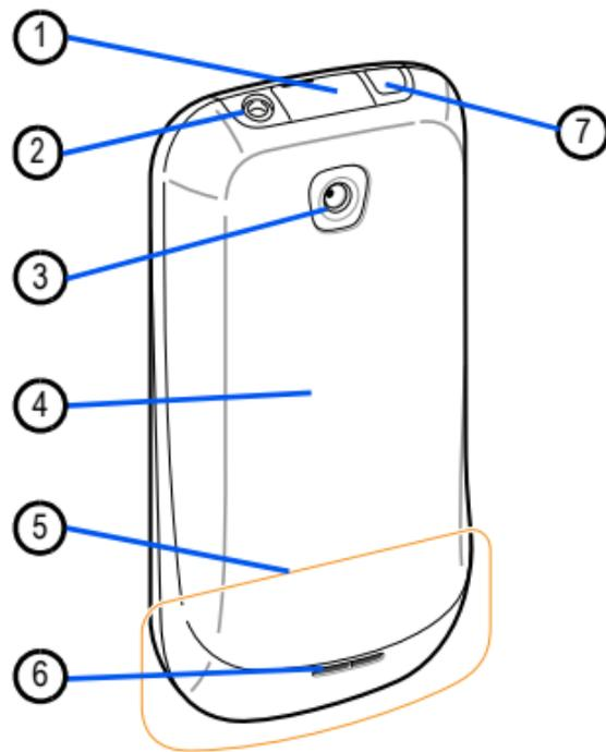
1. **Prise multifonction** : permet de brancher un chargeur de voyage ou d'autres accessoires, tels un câble USB ou autre câble de données.
