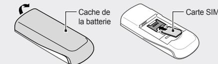
2. Insérez la batterie et remettez le cache en place.
