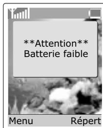
Lorsque le niveau de charge de la batterie est trop faible, le téléphone s'éteint automatiquement.
