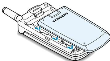
5. Faites coulisser la batterie vers le haut du téléphone jusqu'à ce qu'un déclic retentisse. Avant d'allumer le téléphone, vérifiez que la batterie est correctement installée.
