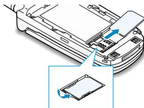
4. Installez de nouveau la batterie en veillant à aligner les languettes de la batterie sur les encoches du téléphone.
