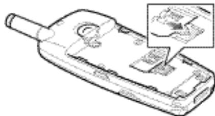
4. Insérez la carte SIM en veillant à ce que le coin biseauté soit placé dans le coin inférieur gauche du logement et que les contacts dorés de la carte soient plaqués contre l'intérieur du téléphone.
