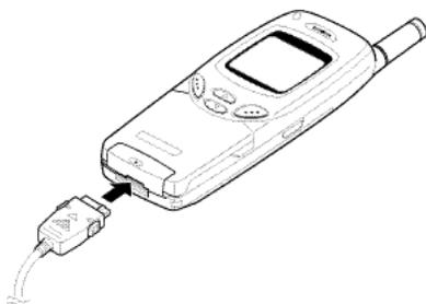
2. Branchez le chargeur sur une prise secteur standard. Lorsque la batterie est en cours de chargement, l'icône correspondante située dans le coin supérieur droit de l'écran se remplit progressivement.
