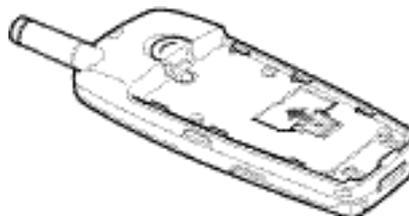
6. Installez de nouveau la batterie sur la face arrière du téléphone. Faites coulisser la batterie vers le haut du téléphone jusqu'à ce qu'un déclic retentisse. Avant d'activer le téléphone, vérifiez que la batterie est correctement installée.
