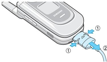
**Remarque :** en cours de chargement, vous devez débrancher le chargeur avant de retirer la batterie sous peine d'endommager le téléphone.
