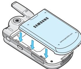
5. Faites glisser la batterie vers le haut du téléphone jusqu'à ce qu'elle s'enclenche. Vérifiez que la batterie est correctement installée avant d'allumer le téléphone.
