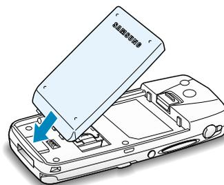
7. Rabattez la batterie sur le combiné jusqu'à ce qu'un déclic retentisse. Avant d'activer le téléphone, vérifiez que la batterie est correctement installée.
