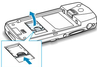
4. Insérez la carte SIM en veillant à ce que le coin biseauté soit placé dans le coin supérieur gauche du logement et que les contacts dorés de la carte soient plaqués contre l'intérieur du combiné.
