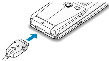
2. Branchez le chargeur sur une prise secteur standard. Lorsque la batterie est en cours de chargement, l'icône correspondante située dans le coin supérieur droit de l'écran se remplit progressivement.
