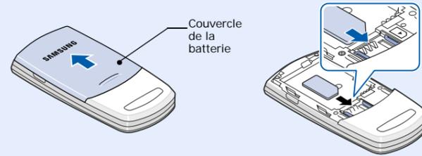
2. Installez la batterie et remettez le couvercle en place.
