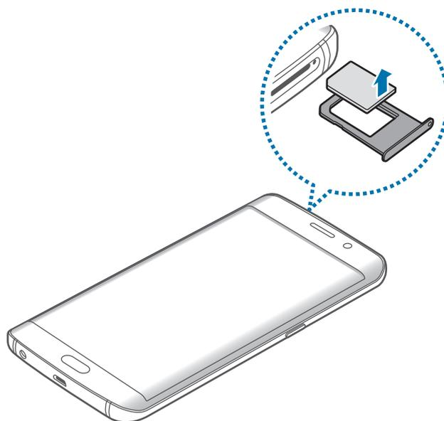
4 Insérez le compartiment pour carte SIM à l'emplacement prévu à cet effet sur l'appareil.
