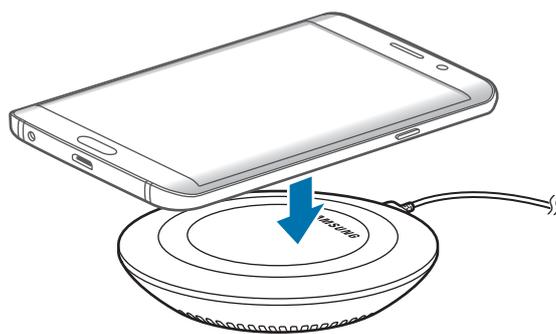
**2** Lorsque la batterie est complètement chargée, ôtez l'appareil de la station de chargement sans fil.
