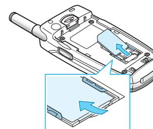
4. Remettez la batterie en place en veillant à aligner les languettes de la batterie sur les encoches du téléphone.
