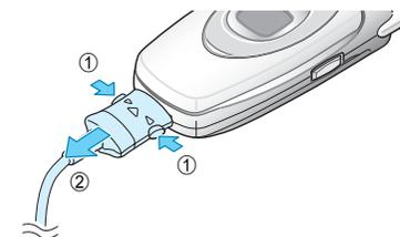
**Remarque** : en cours de chargement, vous devez débrancher le chargeur avant de retirer la batterie sous peine d'endommager le téléphone.
