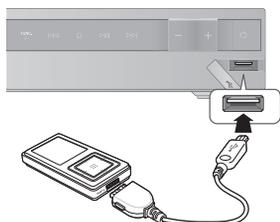
1. Branchez le périphérique USB sur le port USB situé sur l'avant de l'appareil.
