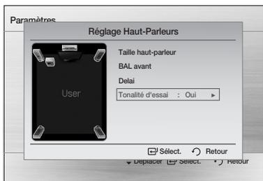
Utilisez la tonalité d'essai pour vérifier les raccordements des enceintes acoustiques.
