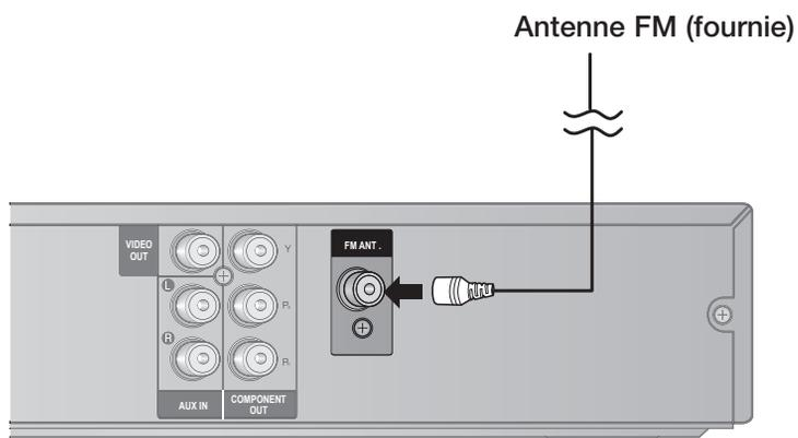
1. Connectez l'antenne FM fournie à la prise d'antenne FM.
