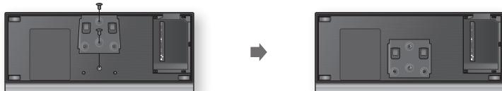
2. Posizionare la staffa per il montaggio a parete in modo che il lato con la freccia sia rivolto verso l'alto e fissarla alla parete con quattro viti (non incluse). Inserire le viti in prigionieri o tasselli per un supporto sicuro.
