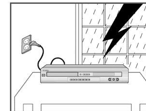
Pendant un orage et/ou une tempête, débranchez le magnétoscope-DHR de la prise murale et de l'antenne.
