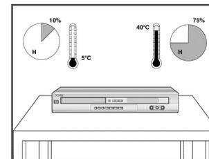
N'exposez PAS le magnétoscope-DHR à des températures extrêmes (inférieures à 5°C ou supérieures à 40°C), ni à une humidité extrême (moins de 10% et plus de 75%).
