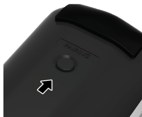
<Touche de pairage de la télécommande Smart Touch Control>
