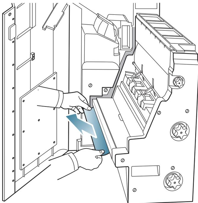
6. Insérez le mécanisme de livret.
