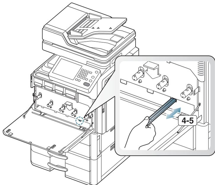
16. Remettez le bâtonnet de nettoyage de la fenêtre du module de numérisation laser en place.
