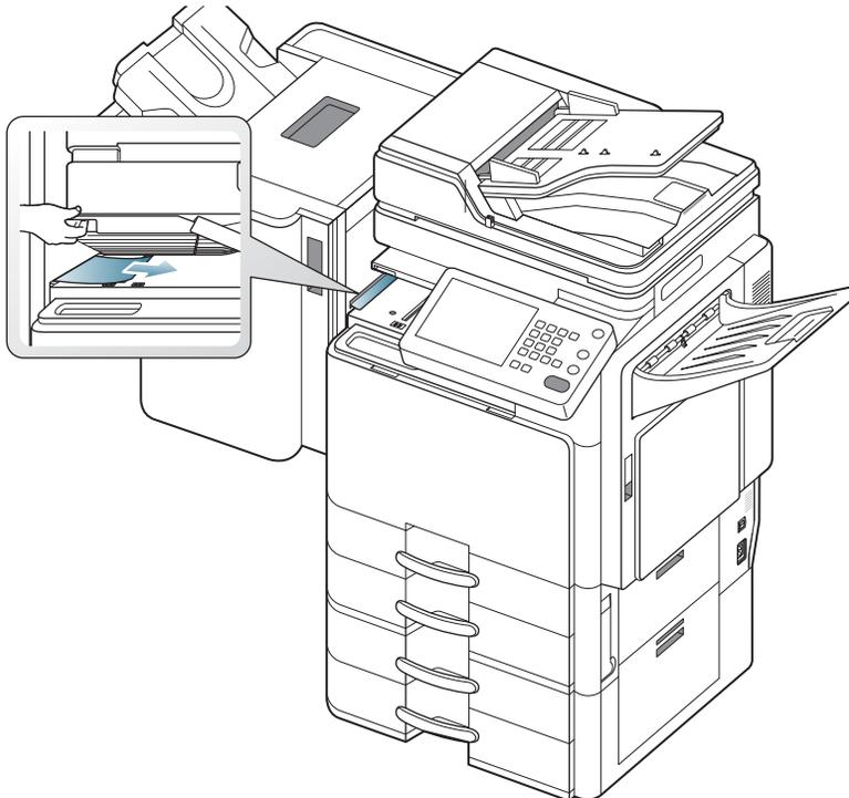
3. Ouvrez et fermez le capot avant du finisseur. L'impression reprend automatiquement.
