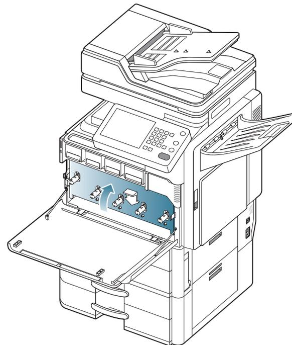
14. Sortez le bâtonnet de nettoyage de la fenêtre du module de numérisation laser.
