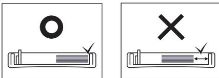
4. Chargez le papier dans le côté gauche du bac avec la face d'impression orientée vers le haut. Le côté gauche du bac peut contenir jusqu'à 1 000 feuilles de papier ordinaire.
