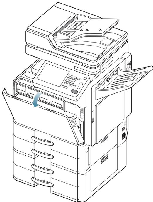
2. Simultanément, maintenez enfoncés les leviers de verrouillage gauche/droite et poussez vers l'extérieur. Retirez ensuite le récupérateur de toner usagé.
