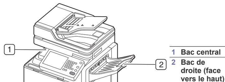
L'appareil envoie l'impression vers le bac de sortie par défaut.
