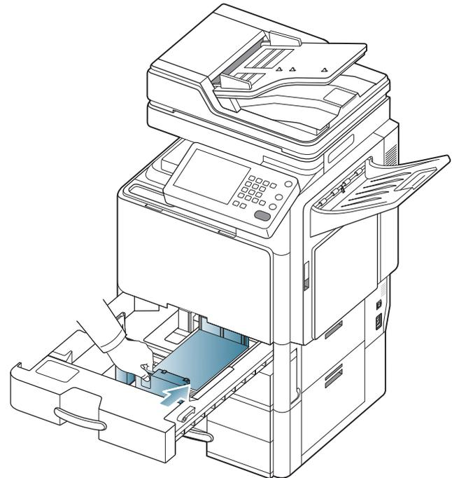
7. Après avoir inséré le papier dans le bac, pincez le guide de largeur de papier et déplacez-le vers la pile de papier jusqu'à ce qu'il touche légèrement le côté de la pile. Évitez de trop appuyer le guide contre le bord du papier, car celui-ci risquerait de se plier.
