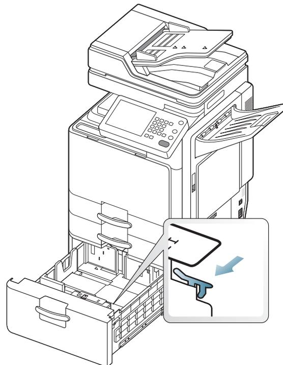
• Si le papier dans le côté droit est épuisé, le guide pousse automatiquement le papier du côté gauche vers le côté droit.
