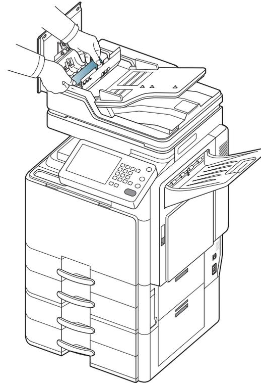
Fermez la trappe d'accès aux bourrages papier recto/verso, puis le capot du chargeur DADF. Remplacez les pages retirées dans le chargeur DADF.
