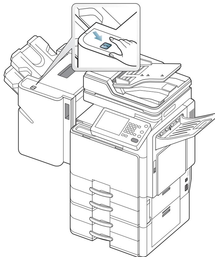
3. La première page des documents imprimés doit se trouver en bas. Insérez les documents dans l'agrafeuse manuelle pouragrafer la partie supérieure droite de ceux-ci.
