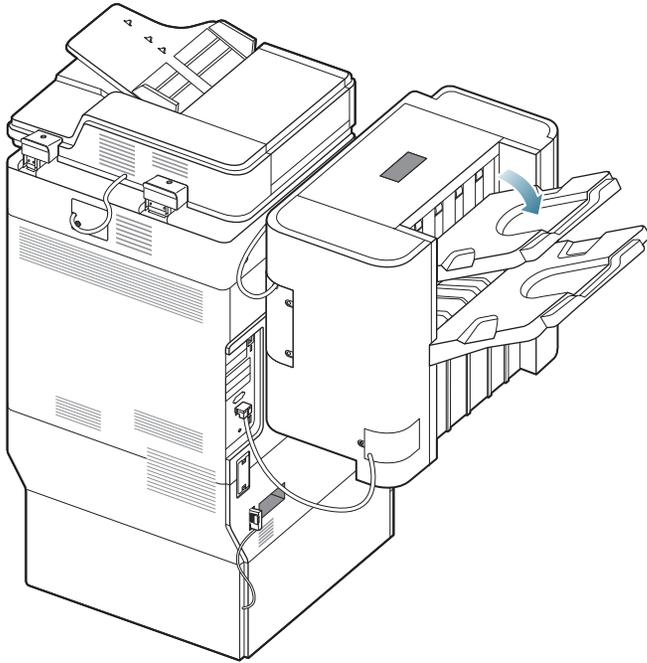
6. Ouvrez et fermez le capot avant du finisseur. L'impression reprend automatiquement.
