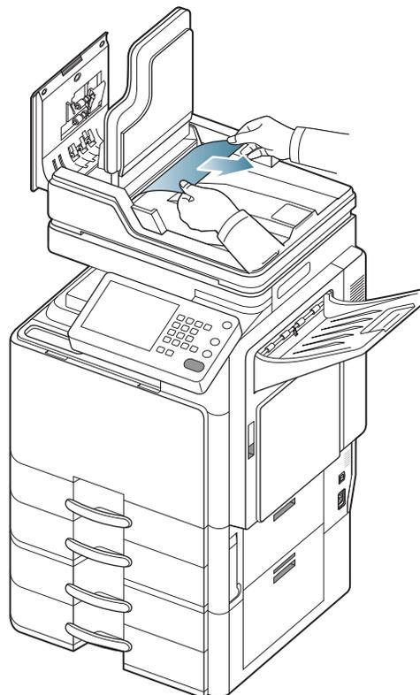
8. Fermez le bac d'alimentation papier, puis le capot du chargeur DADF. Remplacez les originaux retirés dans le chargeur DADF.
