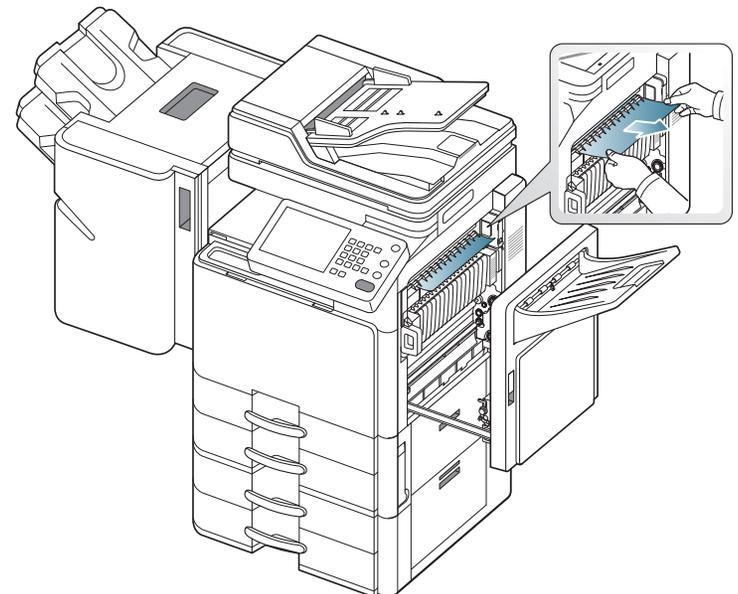
Si ce bouffrage papier persiste, assurez-vous que la cellule de remplissage de bac est dépliée. La cellule de remplissage de bac se
