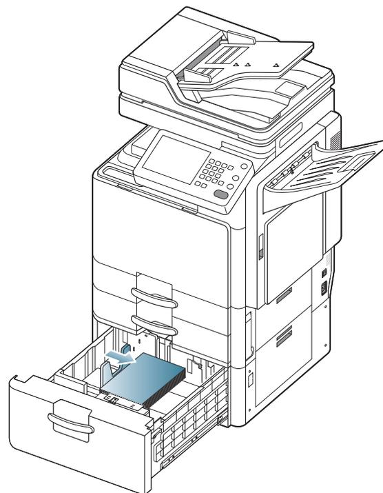
5. Remettez le bac dans le chargeur haute capacité.
