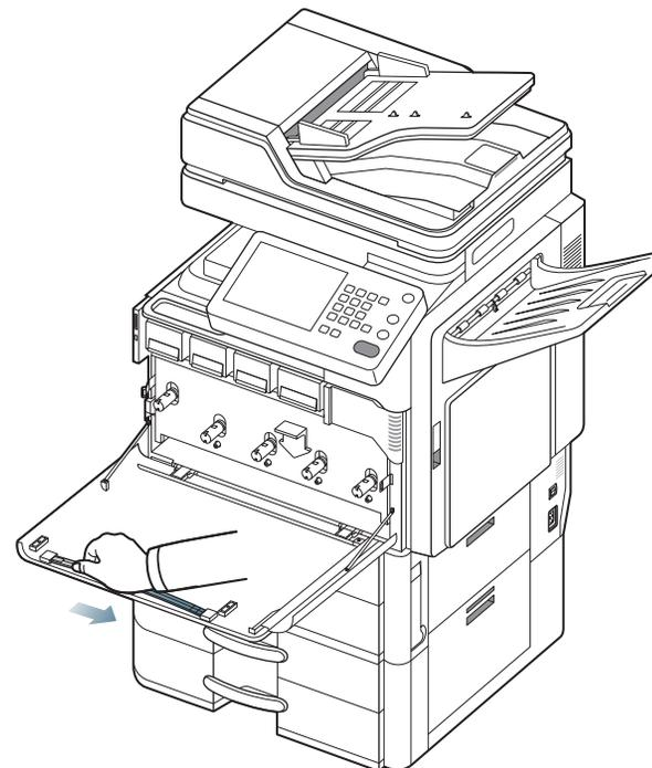
15. Localisez le trou de nettoyage de la fenêtre du module de numérisation laser et insérez son bâtonnet de nettoyage. Poussez et tirez lentement, 4 ou 5 fois, le bâtonnet de nettoyage pour nettoyer la fenêtre du module de numérisation laser.
