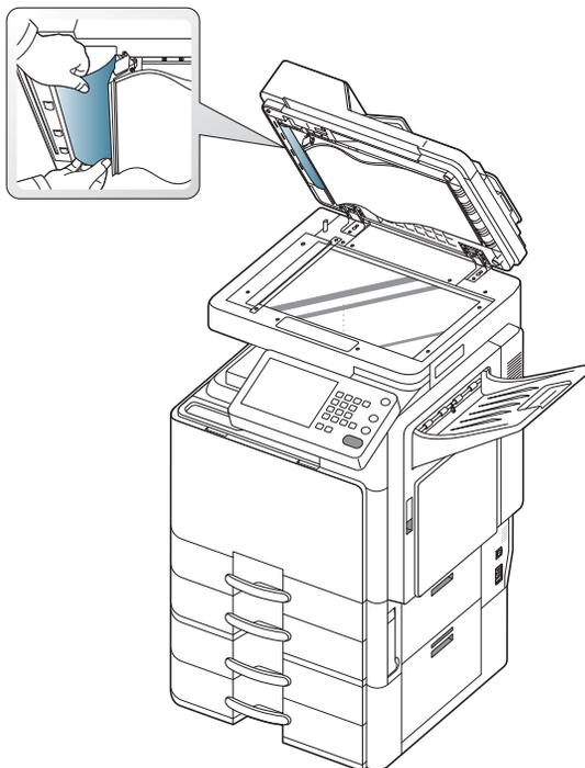
7. Fermez la trappe d'accès aux brouillages papier du chargeur DADF et le chargeur DADF. Remplacez les pages retirées dans le chargeur DADF.
