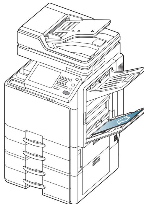
4. Appuyez sur les guides latéraux du bac polyvalent et réglez-les en fonction de la largeur du papier. Ne forcez pas trop, au risque de plier le papier et de provoquer un brouillage papier ou une impression oblique.
