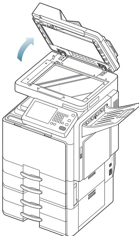
2. Placez l'original face imprimée vers le bas sur la vitre d'exposition et alignez-le sur le guide dans l'angle inférieur gauche de la vitre.
