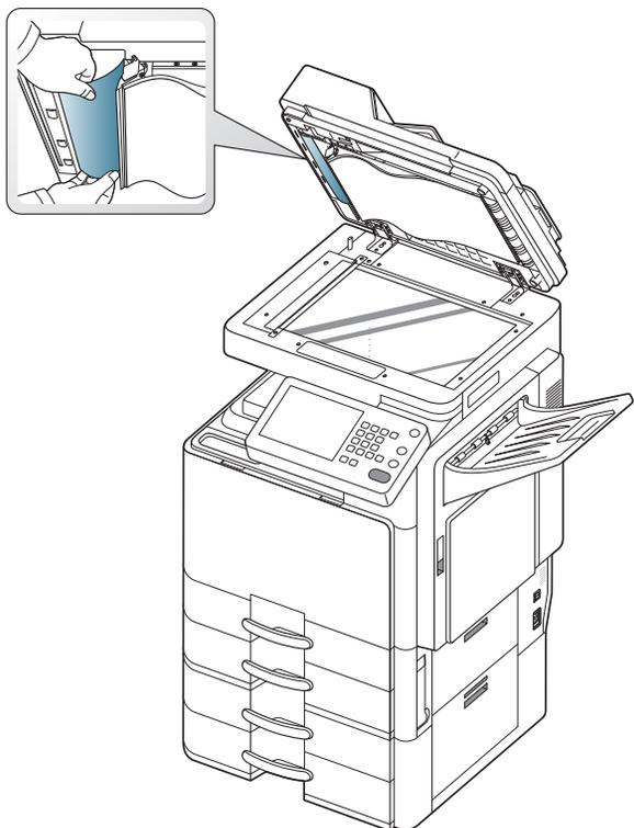
8. Fermez la trappe d'accès aux bouchages papier du chargeur DADF et le chargeur DADF. Remplacez les pages retirées dans le chargeur DADF.
