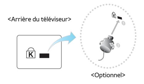
Un antivol Kensington est un dispositif utilisé pour fixer physiquement votre téléviseur lorsqu'il est utilisé dans un endroit public.
