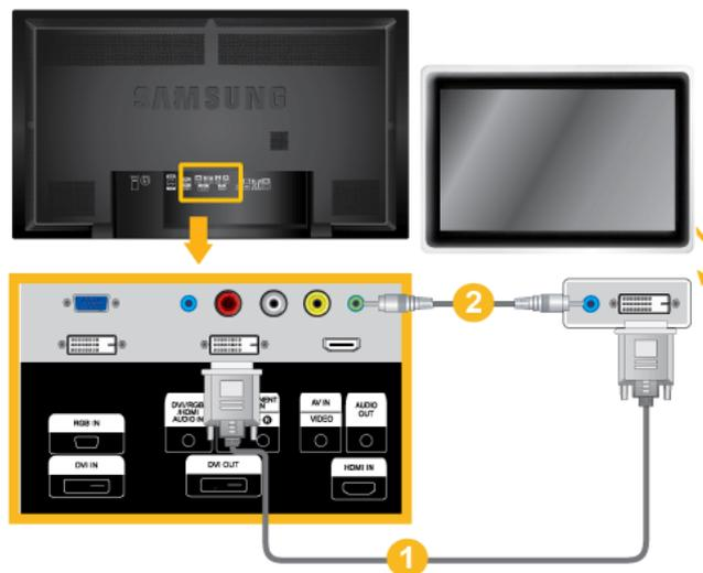
1. Effectuez une connexion entre le port [DVI OUT] de l'écran LCD et le port d'entrée d'un autre moniteur à l'aide d'un câble DVI.
