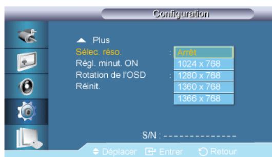
Si l'image ne s'affiche pas correctement à l'écran alors que la résolution de la carte graphique de l'ordinateur est réglée sur 1024 x 768 à 60 Hz, 1280 x 768 à 60 Hz, 1360 x 768 à 60 Hz ou 1366 x 768 à 60 Hz, cette fonction (Resolution Select) permet d'afficher l'image à l'écran à la résolution spécifiée.
