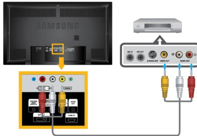
1. Raccordez les ports Vidéo et Audio [AV/COMPONENT AUDIO IN [L-AUDIO-R]] du lecteur DVD, du magnétoscope ou du décodeur DTV aux ports Vidéo et Audio [AV IN [VIDEO]] de l'écran LCD.
