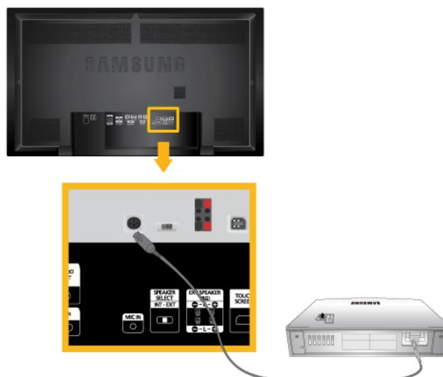
1. Connectez un capteur de microphone sans fil au port [MIC IN] de l'écran.
