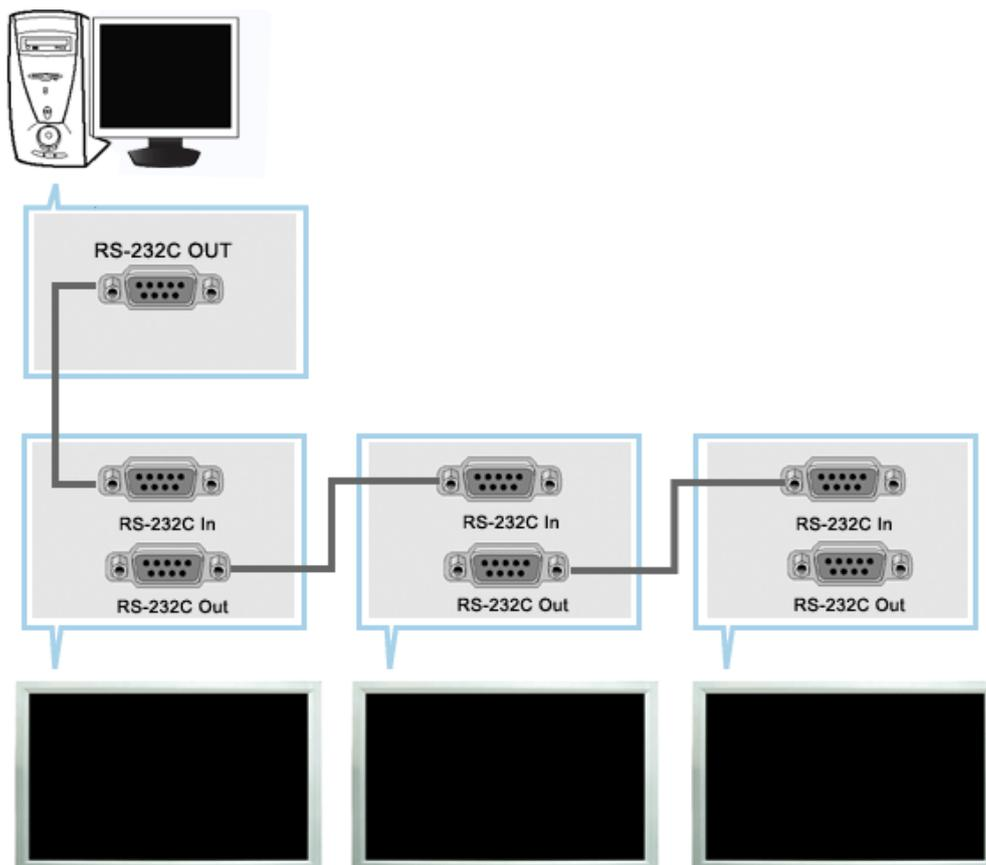
Une Commande d'écrans multiples (MDC) est une application qui permet de contrôler facilement et simultanément divers écrans à partir d'un PC. Le RS-232C, une norme de la communication en série, est utilisé pour assurer la communication entre le PC et l'écran. Par conséquent, un câble en série devra relier le port en série du PC au port en série de l'écran.
