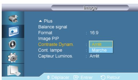
La fonction **Contraste Dynam.** détecte automatiquement la diffusion du signal visuel et l'ajuste pour obtenir un contraste optimal.
