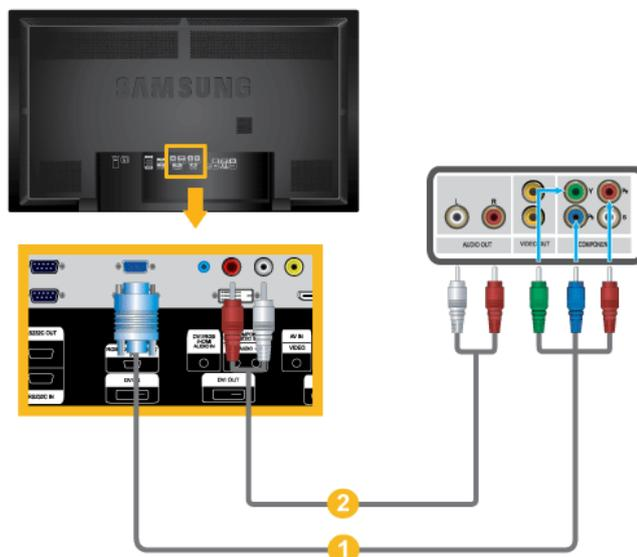
1. Raccordez les ports [RGB/COMPONENT IN] du moniteur aux ports P<sub>R</sub>, Y, P<sub>B</sub> du décodeur à l'aide du câble D-Sub vers Composant.
