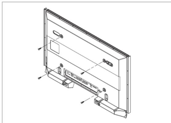
2. Insérez la vis B dans la suspension en plastique.
