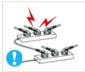
▶ Ne connectez pas plusieurs appareils sur la même prise électrique.
