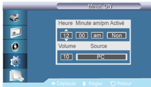
Allume l'écran LCD automatiquement à une heure prédéfinie. Contrôle le mode et le niveau de volume au moment où l'écran LCD se met automatiquement en marche.
