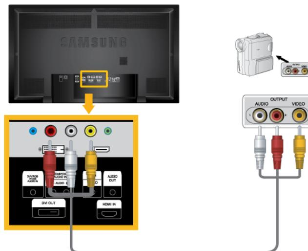
1. Localisez les jacks de sortie AV sur le caméscope. Généralement, ils se situent sur le côté ou au dos du caméscope. Au moyen d'un jeu de câbles audio, reliez les prises
