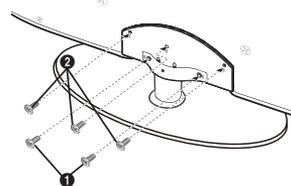
3. Resserrez les deux vis (M4 X L8) à la position **1**, puis resserrez les deux vis (M4 X L8) à la position **2**.
