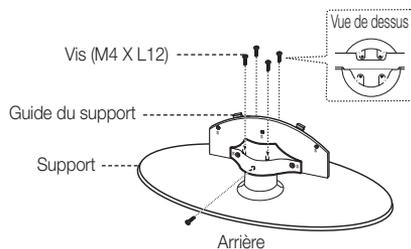
1. Fixez le guide de la base sur la base à l'aide des quatre vis (M4 X L12), tel qu'illustré.
