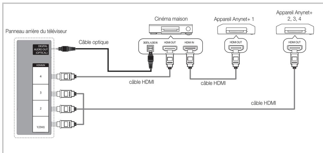
1. Raccordez la prise **HDMI IN(1(DVI), 2, 3 ou 4)** du téléviseur à la prise de sortie **HDMI OUT** de l'appareil Anynet+ correspondant à l'aide du câble HDMI.
