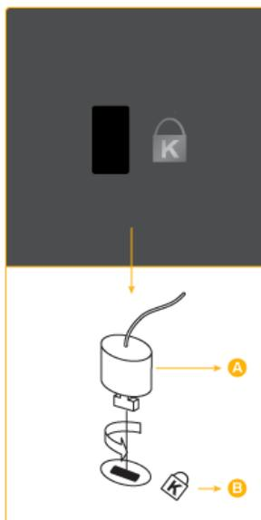
Le verrou Kensington est un périphérique utilisé pour arrimer physiquement le système lorsque vous l'utilisez dans un lieu public. Le dispositif de verrouillage est fourni séparément. L'aspect global et la méthode de verrouillage peuvent différer de ceux présentés sur l'illustration, selon le fabricant. Consultez le manuel fourni avec le verrou Kensington pour obtenir des instructions d'utilisation. Le dispositif de verrouillage est fourni séparément.
