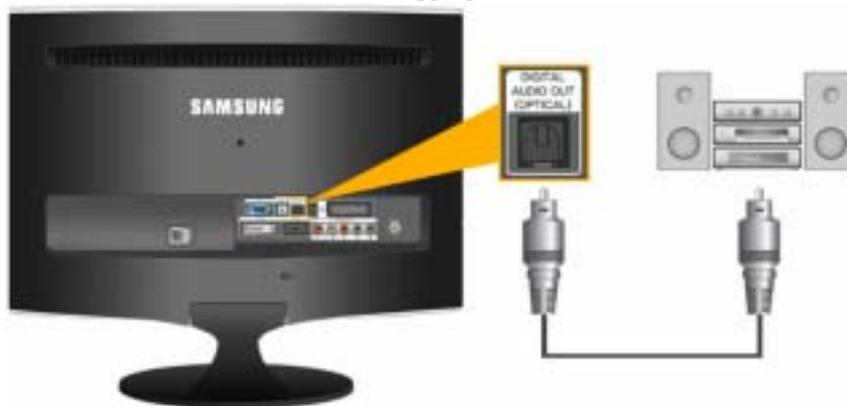
1. Connectez la borne [DIGITAL AUDIO OUT (OPTICAL)] de votre moniteur à la borne d'entrée du son numérique de votre amplificateur numérique à l'aide d'un câble optique.
