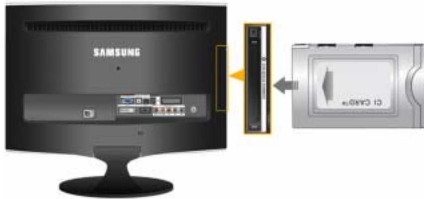
1. Insérez la carte CI dans le module CAM conformément aux indications de la flèche.
