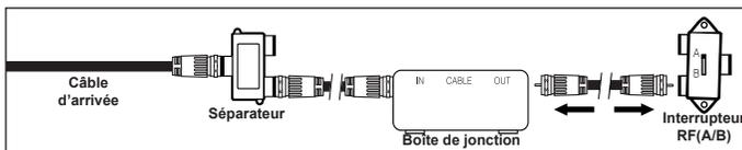
5. Branchez un autre câble entre l'autre prise OUTPUT du séparateur et la prise A.IN de l'interrupteur RF (A/B).
