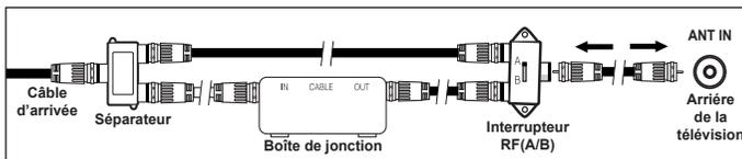
Après avoir établi cette connexion, réglez l'interrupteur A/B en position "A" pour regarder les canal normales. Placez l'interrupteur A/B en position "B" pour une regarder les canal cryptées. (Lorsque vous placez l'interrupteur A/B sur "B", vous devez syntoniser votre télévision sur la canal de sortie de la boîte de jonction qui est habituellement la canal 3 ou 4.)
