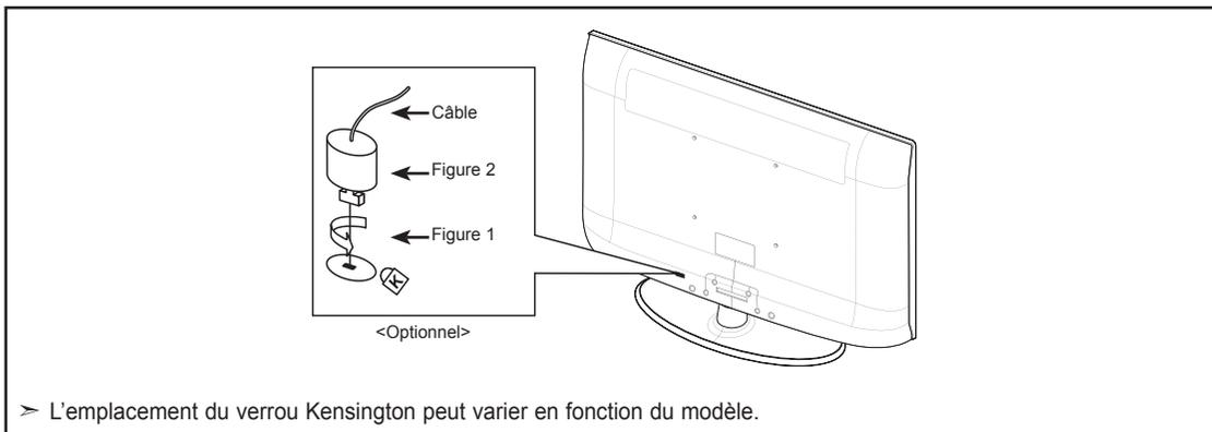
1. Insérez le dispositif de verrouillage dans la fente Kensington de la télévision LCD (Figure 1) et tournez-le dans le sens de verrouillage (Figure 2).
