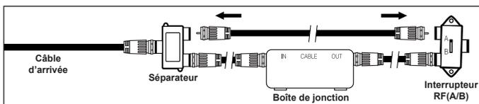
6. Connectez le dernier câble RF entre la borne OUT du commutateur RF (A/B) et la borne ANT IN située à l'arrière du téléviseur.
