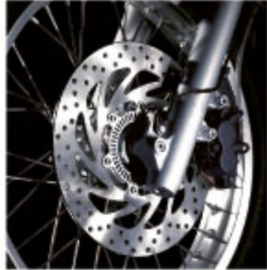
Frein à disque – A l'avant : disque de 300 mm de diamètre et étrier flottant à deux pistons. A l'arrière : disque de 240 mm de diamètre et étrier flottant monopiston.
