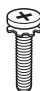
Βίδες βάσης 4ΕΑ, M4 x L21 (Μόνο για τα μοντέλα UB83**~ZG) (Ανατρέξτε στη σελίδα A-3)
