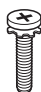
Schroeven van standaard 8EA, M4 x L20 (Alleen UB83*-ZB) (Zie pag. A-4) 4EA, M4 x L20 (Alleen UB80**, UB82**) (Zie pag. A-3)
