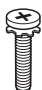
Tornillos del soporte 8EA, M4 x L20 (Solo UB83**-ZB) (Consulte la página A-4) 4EA, M4 x L20 (Solo UB82**) (Consulte la página A-3)
