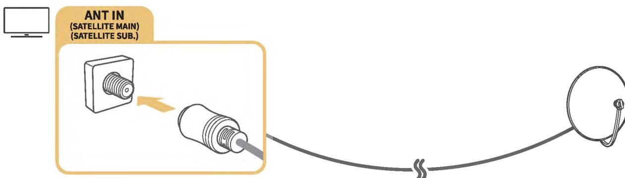
Il est préférable de relier les deux connecteurs à l'aide d'un commutateur multiple ou d'un commutateur DiSEqC, etc. et de définir **Type de connexion d'antenne** sur **Double oscillateur**.
