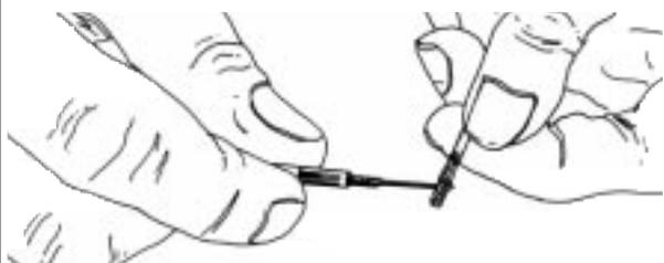
3 - Insérer les broches dans les encoches correspondantes de la prise, vérifier que les ergots ne peuvent ressortir. Contrôler l'ordre de branchement avant de raccorder le variateur sur le récepteur.
