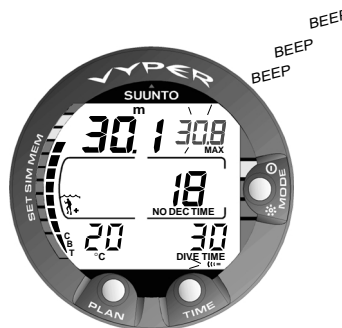
Fig. 3.33. L'alarme de profondeur maximum est activée.
