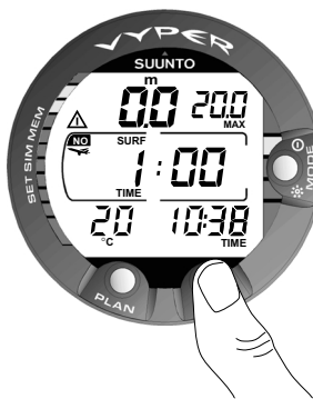
Fig 3.28. Intervalle surface, heure. L'heure s'obtient en appuyant sur le bouton TIME.
