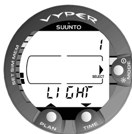
Fig. 4.41. Les réglages de l'éclairage [1 LIGHT].
