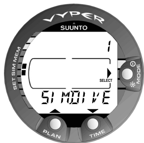
Fig. 4.17. Le simulateur de plongée [1 SIM DIVE].
