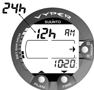
Fig. 4.35. Réglage du format et de l'heure.
