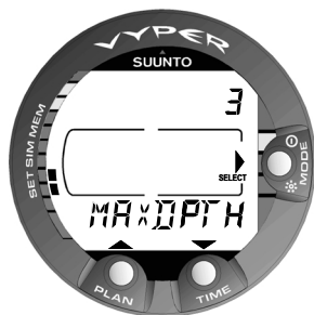
Fig. 4.29. Alarme de profondeur maximum [3 MAX DPTH].
