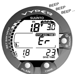
Fig. 3.19. Plongée avec décompression, au-dessus de la profondeur plafond. Plongée avec décompression, au-dessus de la profondeur plafond. Remarquer la flèche pointant vers le bas et la mention d'erreur Er. L'alarme sonore retentit. Redescendre immédiatement (dans les 3 minutes) à la profondeur plafond ou plus bas.
