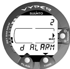
Fig. 4.27. Alarme de temps de plongée [2 d ALARM].
