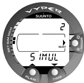
Fig. 4.3. Accès au mode Simulation [2 SIMUL].
