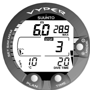
Fig. 3.10. Indicateur de vitesse de remontée. Deux segments.
