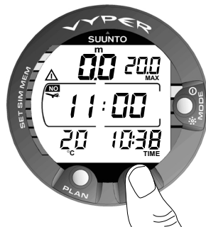
Fig. 3.29. Intervalle surface, temps d'attente avant envol. Le temps d'attente avant envol indiqué par le voyant en forme d'avion s'obtient en appuyant deux fois sur le bouton TIME.
