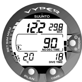
Fig. 3.11. Indicateur de vitesse de remontée. Trois segments.
