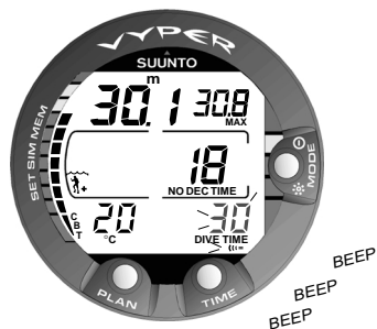
Fig. 3.32. L'alarme de temps de plongée est activée.
