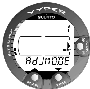
Fig. 4.24. Réglage d'altitude et réglage personnalisé [1 AdJ MODE].
