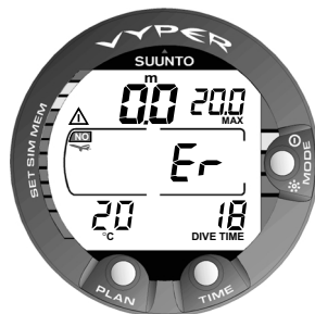
Fig. 3.30. Affichage surface après une plongée où la procédure de décompression n'a pas été respectée. L'abréviation Er indique que la profondeur plafond a été dépassée pendant plus de trois minutes. Ne plus plonger pendant au moins 48 heures.
