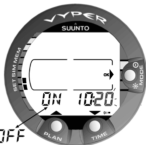
Fig. 4.39. Mise en marche et réglage de l'heure d'alarme.
