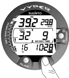
Fig. 3.24. Affichage alterné. L'affichage de l'heure, de la profondeur maximum et du niveau de saturation s'obtient en appuyant sur le bouton TIME.
