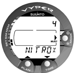
Fig. 4.31. Les réglages oxygène de l'utilisation nitrox [4 NITROX].
