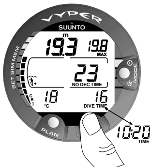
Fig. 3.8. Affichage immersion. La profondeur instantanée est 19,3 m, le temps de plongée sans décompression 23 minutes en mode A0/P1. La profondeur maximum de la plongée est 19,8 m, le temps d'immersion 16 minutes et la température 18°C. L'heure 10:20 s'affiche pendant 5 secondes en appuyant sur le bouton TIME.
