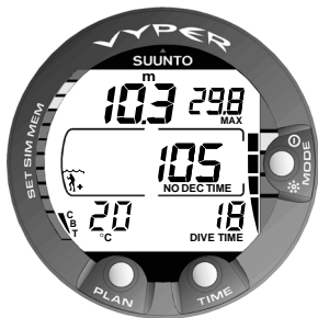
Fig. 3.12. Indicateur de vitesse de remontée. Quatre segments.
