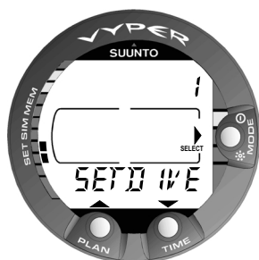
Fig. 4.23. Réglages des paramètres de plongée [1 SET DIVE].
