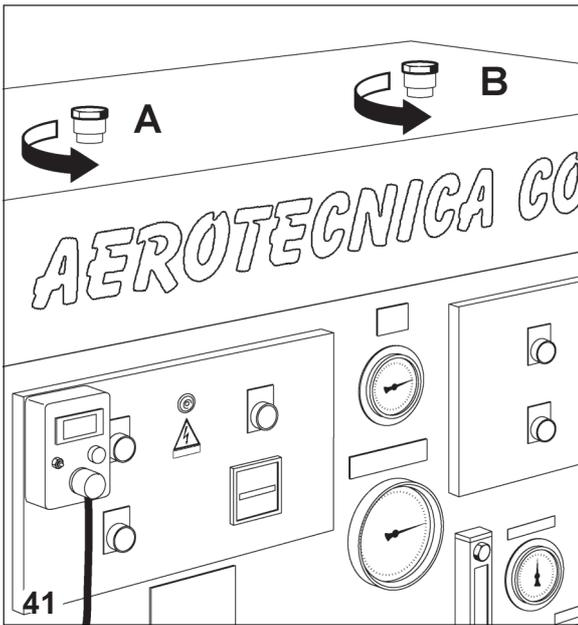
Versez l'huile, après avoir dévissé les deux bouchons de remise à niveau de l'huile placés sur le couvercle supérieur de la machine (Fig. 41) et portant les lettres "A" et "B".
