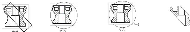
Profil de détail, cercle de détail, style de note avec ligne d'attache et vue de détail
