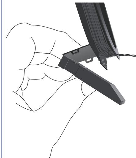
2. Poussez la languette dans la fente ouverte à la base du support. Appuyez jusqu'à ce que la languette se place dans son logement et fasse entendre un dé clic.
