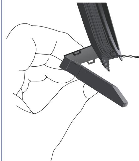
2. Duw de tab in de open sleuf in de basis van de stander. Druk totdat de tab vastklikt.
