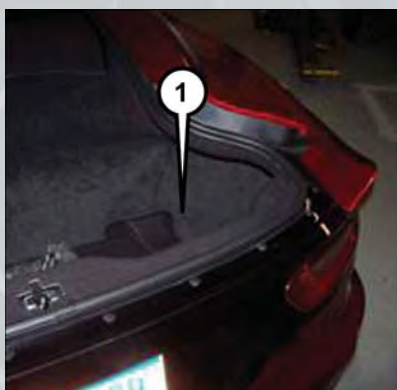
1. Volet d'accès dans la moquette
