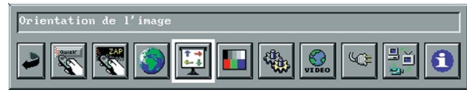
La fonction d'orientation de l'image sert à faire pivoter l'image ou la présenter en miroir. Après avoir mis en évidence l'icône 'Picture orientation', appuyer sur 'Select'. Le mode suivant disponible sera activé selon la séquence suivante :
