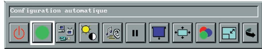
La fonction automatique analyse les signaux venant de l'ordinateur branché et ajuste les paramètres de synchronisation dans le projecteur afin d'assurer la projection d'une bonne image. Les paramètres de synchronisation suivants sont établis par la fonction automatique :
