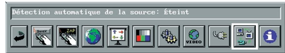
Quand la détection automatique est engagée, le DAVIS HUB commencera automatiquement à chercher un signal valide de tous les inputs. Quand la détection automatique n'est pas engagée, la dernière source utilisée restera active jusqu'à un changement manuel.
