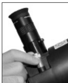
Fig. 10 : insérez l'oculaire et faites la mise au point.
