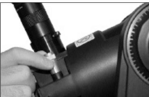
Étape 4 et 6 : insérez un oculaire et faites la mise au point.
