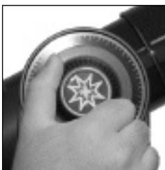
Fig. 7 : desserrez le blocage central et inclinez le tube
