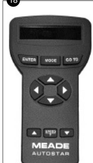
**Fig. 2 : raquette de commande Autostar**
