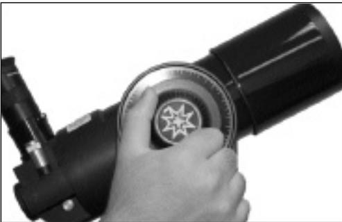
Étape 2 : déserrez le blocage vertical et faites tourner le tube.
